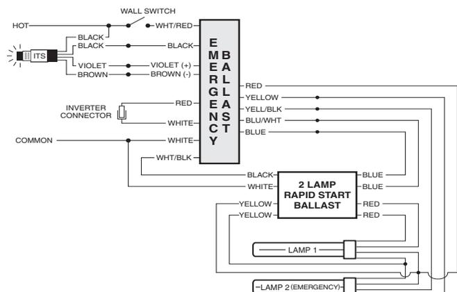
**EMERGENCY BALLAST AND AC BALLAST MUST BE FED FROM THE SAME BRANCH CIRCUIT**
